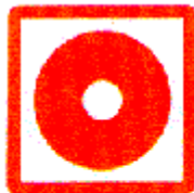
pulsador de alarma
